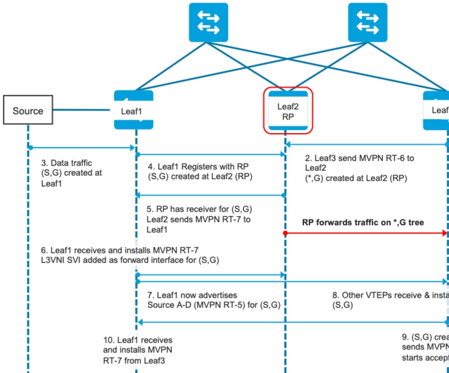
**Schritt EVPN (Leaf-03):** EVPN Typ 5 vom RP wird über LHR gelernt. Dies ist erforderlich, damit der Empfänger-VTEP eine MVPN-Typ-6-Route erstellen kann.
