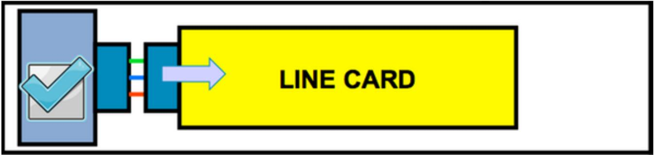
2) Wenn die Linecard herausgezogen wird, wird der Kontakt mit dem Kurzstift (blau dargestellt) unterbrochen, und auf der Rückwandplatine wird ein Haltesignal platziert, um das System vor Datenbeschädigungen zu schützen. Die Karte ist heruntergefahren.
