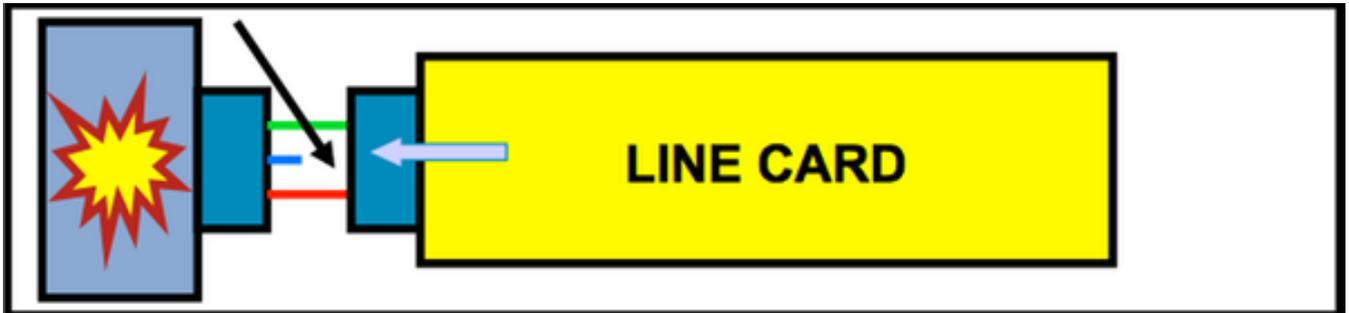
4) Wenn die Linecard in dem Zustand verbleibt, in dem nur die längsten und zweitlängsten Pins kontaktiert werden, bleibt der Stillstand bestätigt, und das System stürzt ab.
