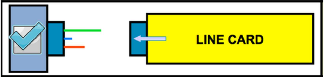
2) Wenn die Linecard zuerst den längsten Pin erreicht (grün dargestellt), wird die Karte mit einem Netzteil versorgt, die Karte jedoch noch nicht mit Strom versorgt. Die Karte wird nur eingeschaltet, wenn alle Pins in Kontakt sind.
