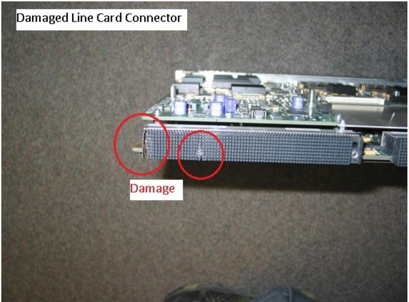
Beispiel für beschädigten Anschluss der Chassis-Rückwandplatine
