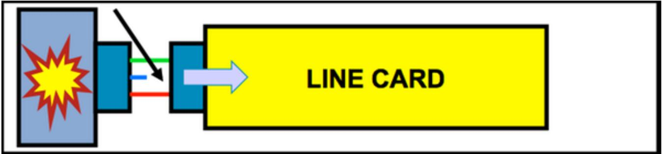
3) Wenn die Linecard den ersten Kontakt mit dem zweitlängsten Stift (rot dargestellt) verliert, wird der Stillstand aus dem System entfernt und der Datenfluss wird wieder aufgenommen.
