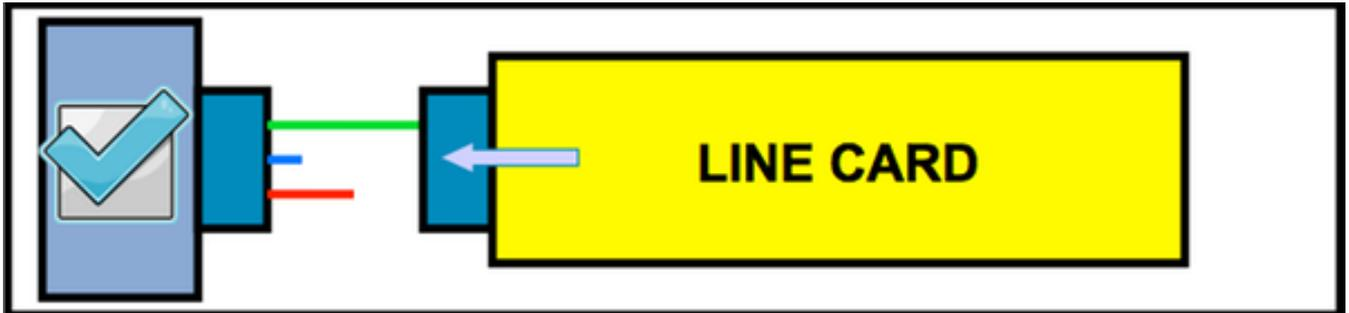
3) Wenn die Linecard auf den zweitlängsten Pin trifft (rot dargestellt), wird ein Haltesignal auf die Rückwandplatine gesetzt, um das System vor Datenbeschädigungen zu schützen.
