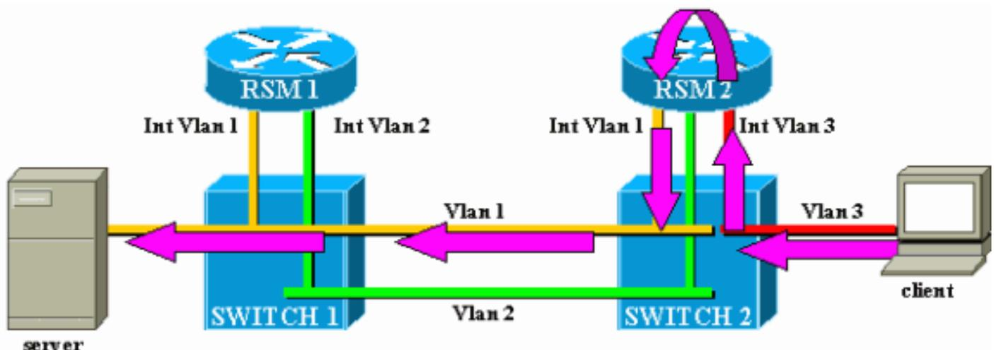
Berücksichtigen Sie nur den Datenverkehr vom Client zum Server. Eingehender Datenverkehr vom Client in VLAN3 wird von RSM2 geroutet, das über seine Schnittstelle VLAN2 eine direkte Verbindung zum Subnetz des Servers hat. Die lila Pfeile stellen den folgenden Pfad dar:
