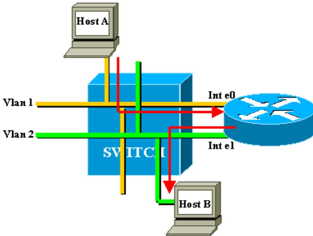
In diesem Diagramm werden die beiden VLANs als zwei verschiedene Ethernet-Segmente betrachtet. Der VLAN-übergreifende Datenverkehr muss über den externen Router geleitet werden. Wenn Host A mit Host B kommunizieren möchte, verwendet er in der Regel den Router als Standard-Gateway.
