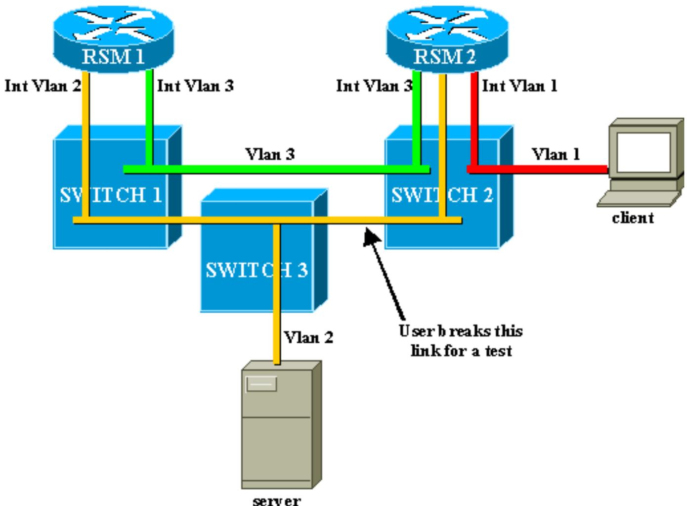
Um einen Test durchzuführen, unterbricht ein Benutzer die Verbindung zwischen Switch 2 und Switch 3. Der entsprechende Port wird sofort deaktiviert, und die RSM Autostate-Funktion führt zum Ausfall der Schnittstelle VLAN2 auf RSM2. Die direkt verbundene Route für den Server verschwindet aus der Routing-Tabelle von RSM2, die schnell eine neue Route über RSM1 erfährt.
