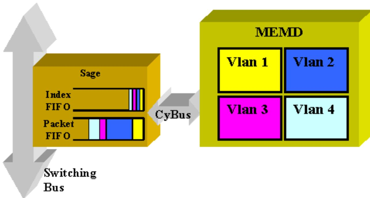
Die Ziel-VLAN-Schnittstelle wird nicht vom Inhalt des Pakets selbst bestimmt, sondern vom Index abgeleitet. Das Paket und der Index werden zunächst in zwei verschiedenen FIFOs im SAGE gespeichert. Der Index wird gelesen, und der erforderliche gemeinsam genutzte Speicher ist im Bereich des Ziel-VLANs reserviert. Das Paket wird dann mithilfe eines Direct Memory Access (DMA) in das Speichergerät (MEMD) kopiert.
