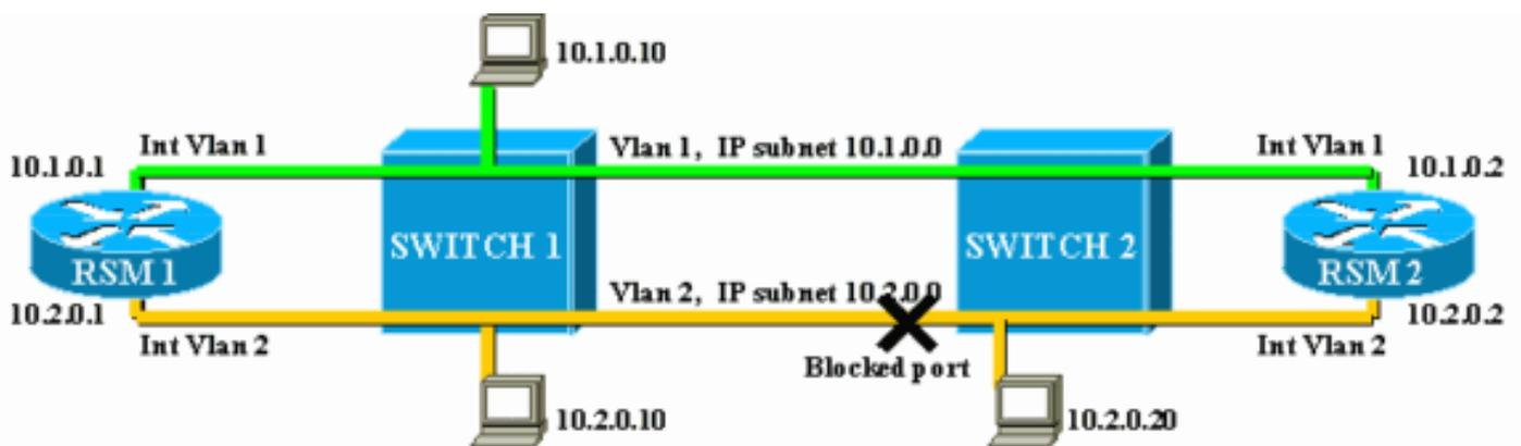
VLAN2 ist in zwei Teile unterteilt, und Sie haben ein nicht zusammenhängendes Subnetz 10.2.0.0. Bei dieser Konfiguration kann Host 10.2.0.10 nicht mit Host 10.2.0.20 kommunizieren, obwohl sie sich im gleichen Subnetz und VLAN befinden.
