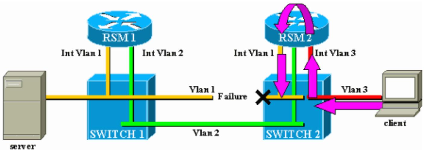
Angenommen, die Verbindung zwischen Switch 1 und Switch 2 bricht für VLAN1. Das Hauptproblem dabei ist, dass sich aus Sicht von RSM2 nichts im Netzwerk verändert hat. RSM2 verfügt weiterhin über eine Schnittstelle, die direkt mit VLAN1 verbunden ist. Über diesen Pfad wird der Datenverkehr vom Client zum Server weitergeleitet. In Switch 2 geht Datenverkehr verloren, und die Verbindung zwischen Client und Server ist unterbrochen.
