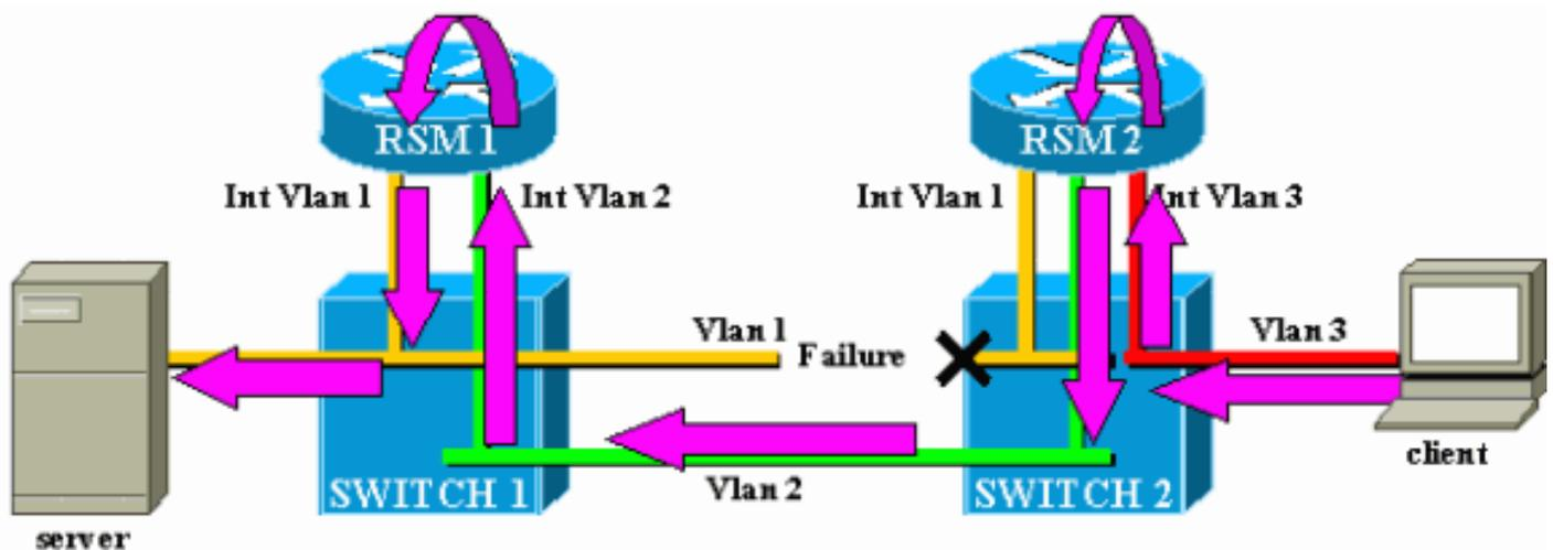
Der automatische RSM-Status funktioniert nur, wenn im VLAN kein anderer Port vorhanden ist. Wenn beispielsweise ein anderer Client in VLAN1 an Switch 2 oder ein RSM im Chassis angeschlossen ist und eine Schnittstelle für VLAN1 definiert ist, wird die Schnittstelle VLAN1 nicht
