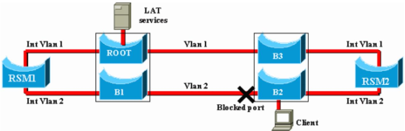
Für dieses Diagramm ist jeder Catalyst in zwei verschiedene Bridges aufgeteilt (eine für jedes VLAN). Sie sehen, dass die Überbrückung zwischen den beiden VLANs zu einer Fusion der beiden VLANs führte. Was überbrückte Protokolle angeht, so verfügen Sie nur über ein VLAN, und der LAT-Server und -Client können direkt miteinander kommunizieren. Natürlich impliziert dies auch, dass Sie eine Schleife im Netzwerk haben und dass STP einen Port blockieren muss.
