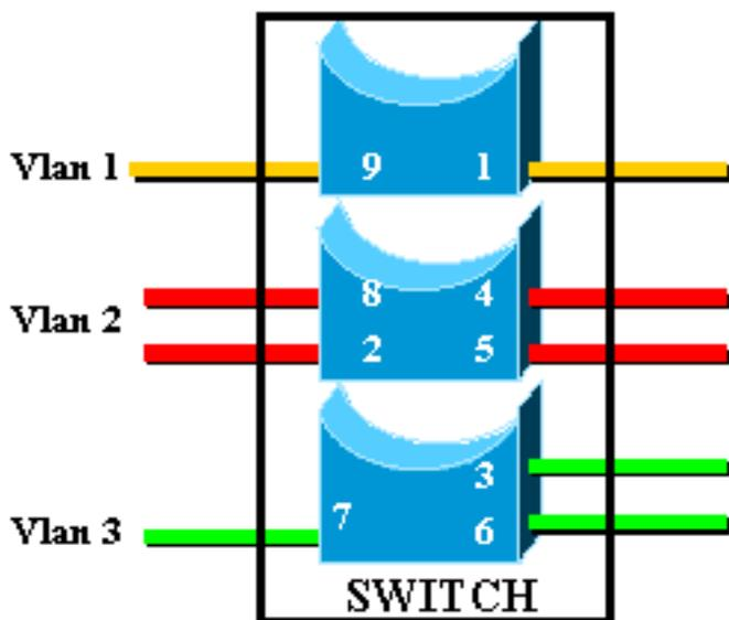
Im Switch gibt es drei verschiedene Bridges, da jedes VLAN eine separate Bridge erstellt. Da jedes VLAN eine separate STP-Instanz (Spanning Tree Protocol) erstellt, unterhält STP drei verschiedene Weiterleitungstabellen.
