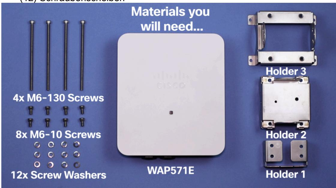
Der erste Schritt der Mastmontage erfordert einen kleinen Mast mit einem Durchmesser von maximal 3 Zoll. Nachdem Sie Holder\_1 an das Gerät angeschlossen haben, nehmen Sie Holder\_2 und Holder\_3 und platzieren Sie sie an den gegenüberliegenden Enden des Masts. Sichern Sie die Halterungen mit den 4 M6\*130-Schrauben und -Unterlegscheiben so zusammen, dass sie um den Mast herum befestigt sind. Montieren Sie schließlich den
