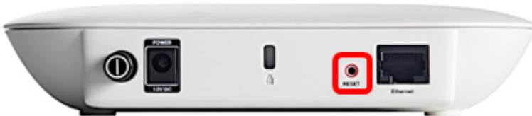
Schritt 2: Lassen Sie die **Reset**-Taste los, wenn die LEDs wieder leuchten.
