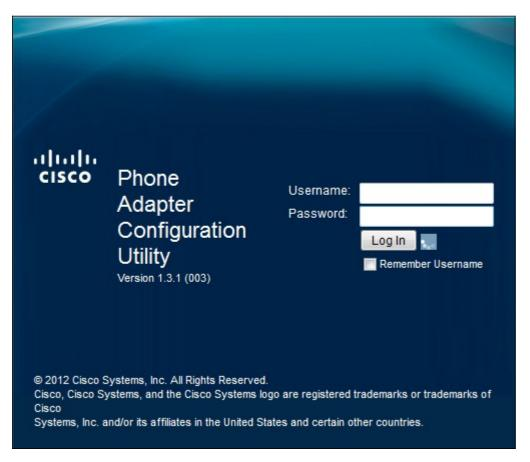
Die Standard-IP-Adresse des Telefonadapters lautet 192.168.15.1. Wenn keine Webseite angezeigt wird, versuchen Sie, die IP-Adresse zurückzusetzen. Halten Sie die Reset-Taste 30 Sekunden lang gedrückt, um die IP-Adresse zurückzusetzen. Dadurch werden die Standard-IP-Adresse sowie alle anderen Einstellungen auf die Werkseinstellungen zurückgesetzt. Alternativ
