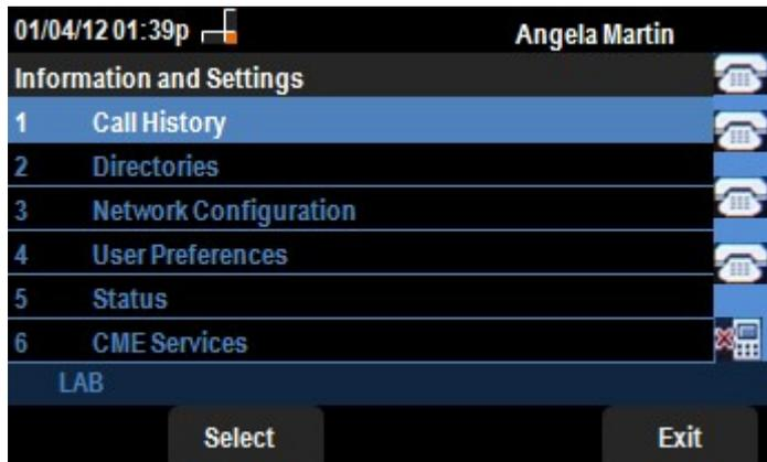
Schritt 2: Navigieren Sie mithilfe der Navigationstasten nach unten zu Netzwerkconfiguration. Drücken Sie die programmierbare Taste **Select (Auswählen)**. Das Menü *Network Configuration* (Netzwerkconfiguration) wird angezeigt. Scrollen Sie mithilfe der Navigationstasten nach unten zur VLAN-Option.
