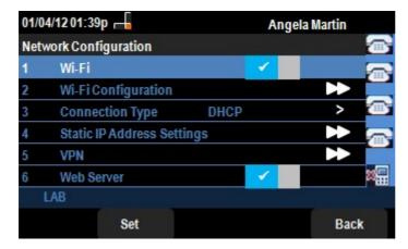
Schritt 3b (optional). Wenn in Schritt 3a in Zeile 1 kein Häkchen angezeigt wird, muss Wi-Fi aktiviert sein. Dieses Bild zeigt, dass Wi-Fi deaktiviert ist.
