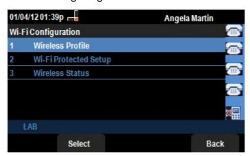
Schritt 5: Navigieren Sie mithilfe der Navigationstasten nach unten zu Wireless-Status. Drücken Sie die programmierbare Taste **Select** (**Auswählen**). Das Menü *Wireless Status* (*Wireless-Status*) wird auf dem Bildschirm angezeigt.
