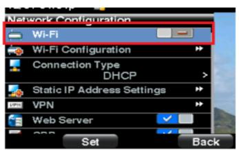
Schritt 3c (optional). Wenn die Wi-Fi-Leitung ausgewählt ist, drücken Sie die Pfeiltaste nach rechts oder links, um das Auswahlkästchen anzuzeigen. Dieses Bild zeigt die Wi-Fi-fähige.
