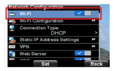
Schritt 3d. Stellen Sie sicher, dass das Telefon nicht mit Ethernet verbunden ist. Sie können Wi-Fi aktivieren, während Sie mit Ethernet verbunden sind, aber Sie können nicht auf das Internet zugreifen.
