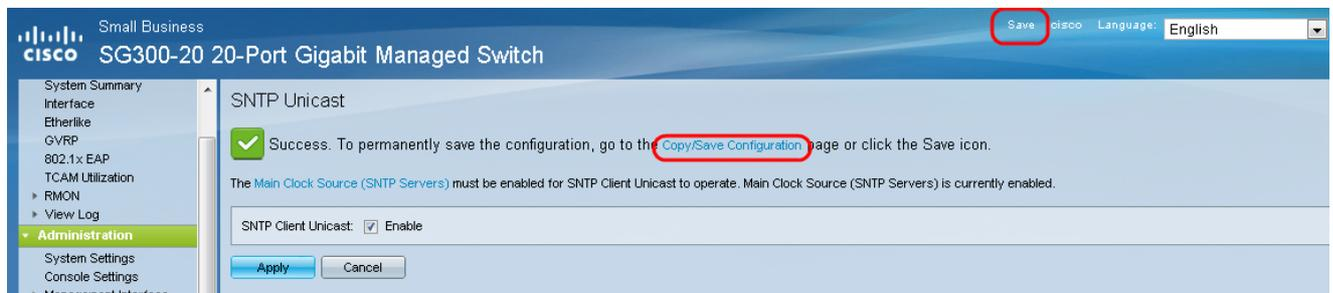
Schritt 18: Speichern Sie die aktuelle Konfiguration in der Startkonfiguration, indem Sie im Feld *Quelldateiname* die Option **Running Configuration** und im Feld *Zieldateiname* die Option **Startup Configuration** auswählen.
