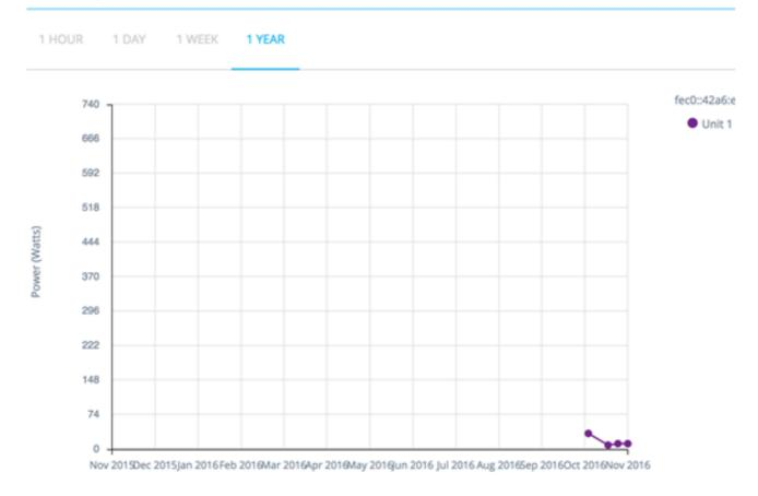
Die Daten werden als eine Anzahl Watt (0 ist die PoE-Kapazität der ausgewählten Einheit mit der höchsten Kapazität) angezeigt, wobei die Anzahl und Häufigkeit der Stichproben je nach der angezeigten Zeitskala variieren:
