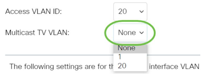
Die folgenden Einstellungen gelten für die Inaktivitäts-VLAN-Modi. Diese Effekte werden gespeichert, werden jedoch erst wirksam, wenn der VLAN-Modus der Schnittstelle auf der Seite VLAN Interface Settings (VLAN-Schnittstelleneinstellungen) geändert wird. Weitere Informationen zur Konfiguration dieser Funktion erhalten Sie hier.
