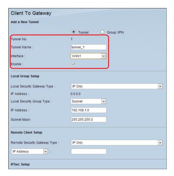
Schritt 2: Geben Sie im Feld Tunnelname einen Namen für den Tunnel ein.
