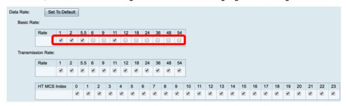
Schritt 7: Aktivieren Sie im Bereich Transmission Rate (Übertragungsrate) die Kontrollkästchen der erforderlichen Übertragungsraten bei der Bandbreite Ihres Wireless-Netzwerks. Die Standardeinstellung ist, dass alle Kontrollkästchen aktiviert sind.
