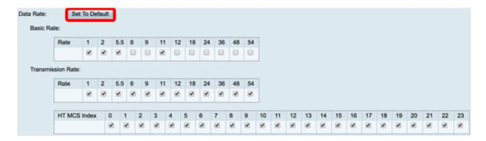
Schritt 6: Aktivieren Sie in der Tabelle Basic Rate (Grundrate) die Kontrollkästchen der anwendbaren Raten in Mbit/s (Mbit/s), bei denen das 2,4-GHz-Funkmodul übertragen wird. Die Standardraten sind 1 Mbit/s, 2 Mbit/s, 5,5 Mbit/s und 11 Mbit/s.
