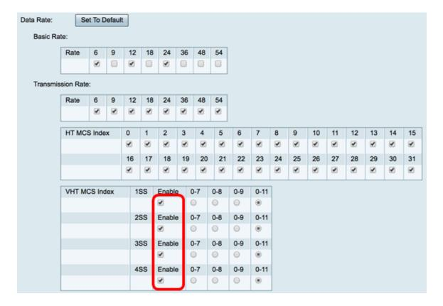
Schritt 9: Klicken Sie auf ein Optionsfeld, um die Geschwindigkeit auszuwählen, mit der die VHT MCS unterstützt wird.
