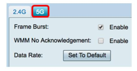
Schritt 2: Aktivieren Sie das Kontrollkästchen **Enable** Frame Burst (Frame-Burst aktivieren), damit das Funkmodul kurze Zeit nacheinander eine Reihe von Frames schnell senden kann. Frame-Burst verbessert die Fähigkeit eines Clients, Daten bei höheren Durchsätzen hochzuladen, indem Interframe-Warteintervalle zum Bersten einer Sequenz von bis zu drei Paketen verwendet werden, bevor dieser auf einen bestimmten Zeitraum warten muss. Die Standardeinstellung ist deaktiviert.
