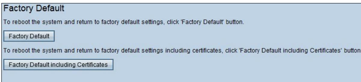
Schritt 1: Klicken Sie auf **Werkseinstellungen mit Zertifikaten**, um den Router auf die Werkseinstellungen zurückzusetzen, einschließlich aller von Ihnen generierten Zertifikate. Die Bestätigungsmeldung wird angezeigt.
