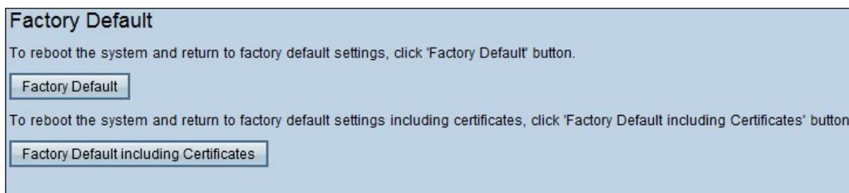
Schritt 2: Klicken Sie auf **Werkseinstellungen**, um den Router auf die Werkseinstellungen zurückzusetzen. Eine Bestätigungsmeldung wird angezeigt.
