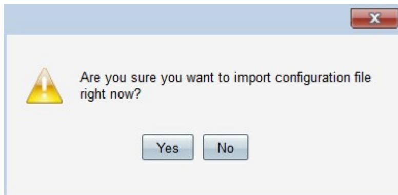
Schritt 4: Klicken Sie auf **Ja**. Der Router wird automatisch neu gestartet, und die Startkonfiguration wird wiederhergestellt.
