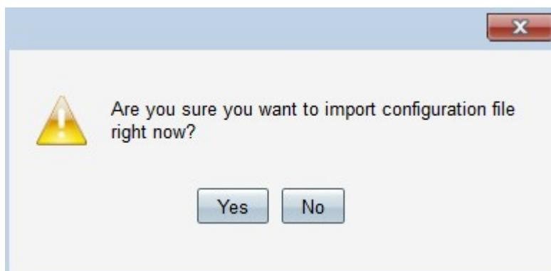
Schritt 5: Klicken Sie auf **Ja**. Der Router wird automatisch neu gestartet, und die Startkonfiguration wird wiederhergestellt.
