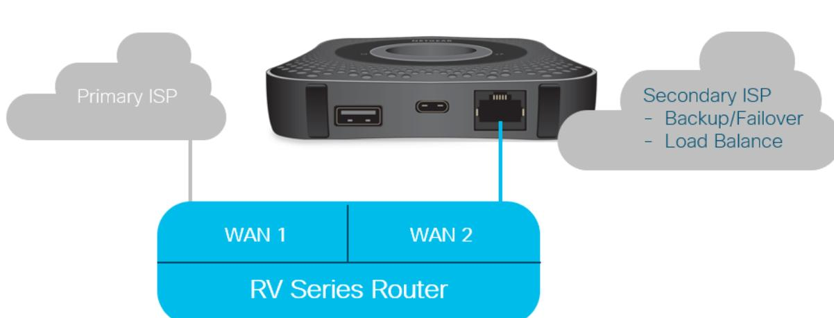
Bevor Sie den LTE-Router mit dem RV340-Router verbinden, befolgen Sie die unten stehenden Anweisungen, um den LTE-Router als Backup-Internet einzurichten.
