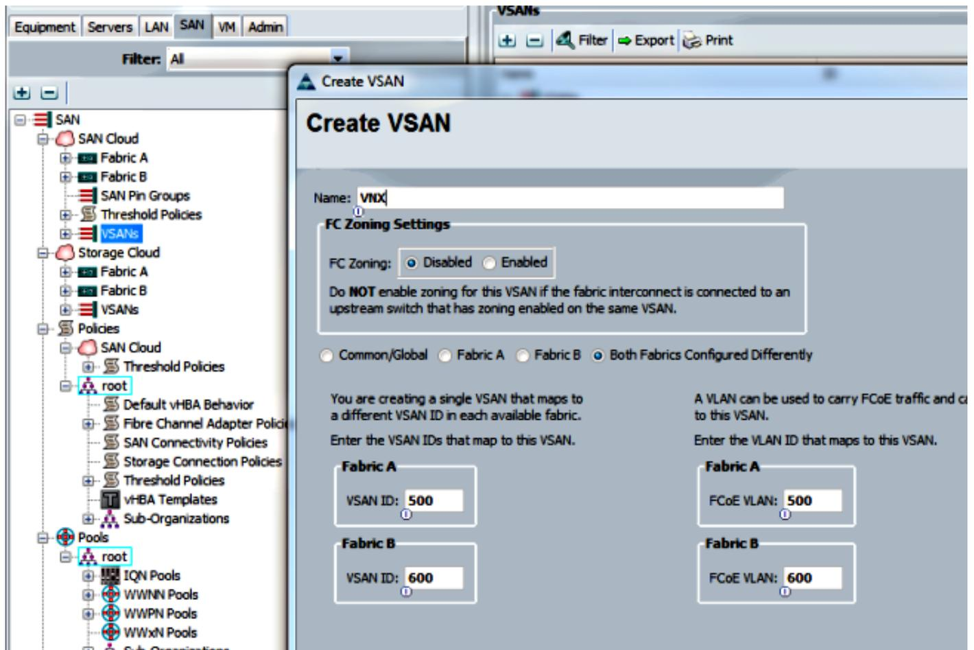
In dieser Konfiguration ist VSAN 500 nicht in Fabric A, VSAN 600 nicht in Fabric B. Dies ist die gleiche Konfiguration, die Sie zum Erstellen eines VSAN für eine normale FC verwenden würden.
