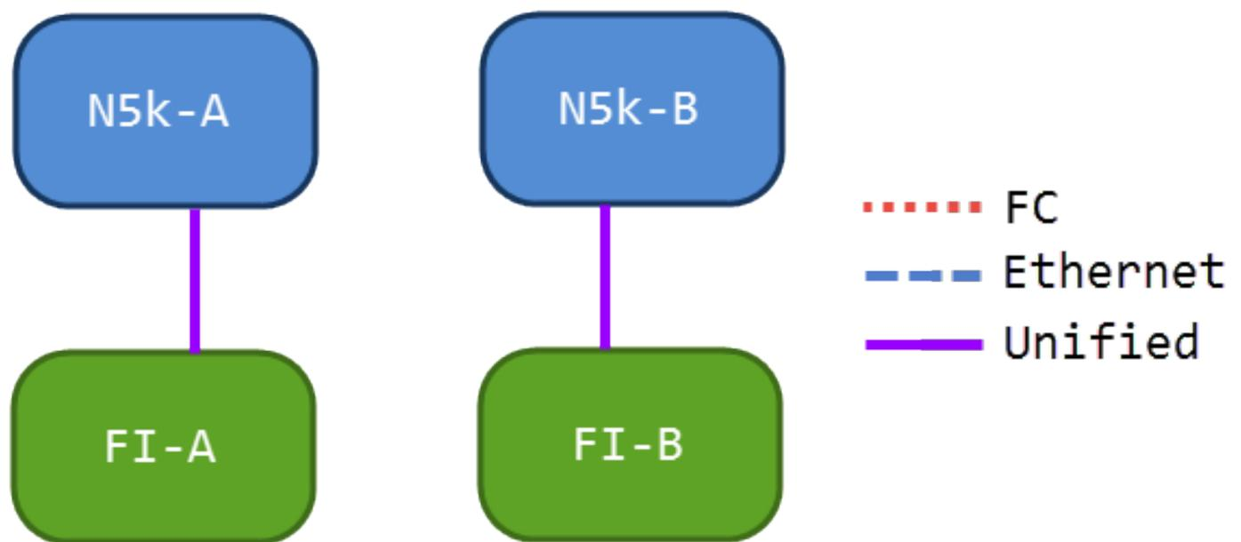
Diese Konfiguration bietet die größte Konsolidierung. Beachten Sie, dass diese Links auch Port-Channels sein können, aber alle Links Unified Uplinks sein müssen. Dies ist wahrscheinlich die häufigste Implementierung.
