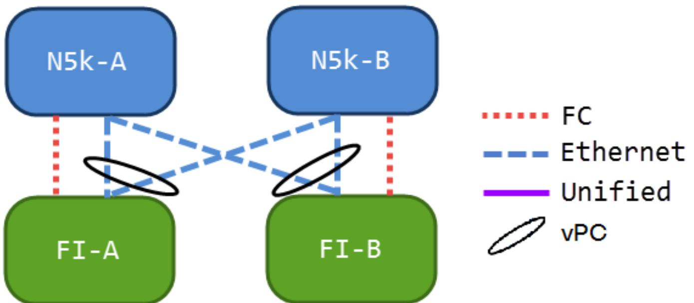
Diese Konfiguration enthält keine einheitlichen Links, sie ist jedoch die einfachste Möglichkeit, FCoE-Uplinks in Ihre aktuelle Umgebung zu integrieren. Dank dieser Konfiguration müssen die FC-Fabrics nicht mehr überquert werden.
