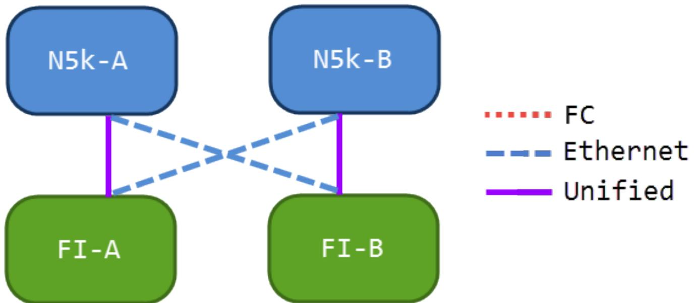
In dieser Konfiguration sind die Nexus Switches der Serie 5000 (N5ks) und FIs miteinander verbunden, aber nicht über einen Port-Channel verbunden. So können Sie einige Unified-Uplinks nutzen, aber weiterhin ein bekanntes Netzwerkdesign verwenden.
