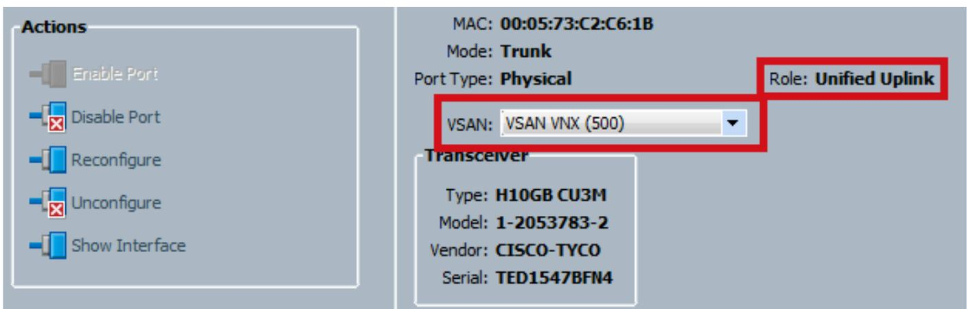
Zu diesem Zeitpunkt ist Ihr UCS für einheitlichen Datenverkehr konfiguriert. In diesem Beispiel werden keine Port-Channels verwendet. Sie können Port-Channels jedoch zu diesem Zeitpunkt normal konfigurieren. Stellen Sie das VSAN auf der Registerkarte VSAN für den Port-Channel ein.
