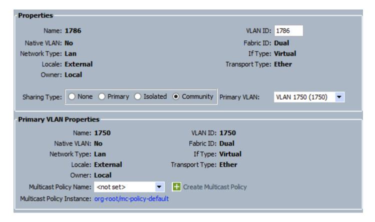
3. Die virtuelle Netzwerkschnittstellenkarte (vNIC) im Serviceprofil überträgt reguläre VLANs sowie PVLANs, wie im Bild dargestellt.
