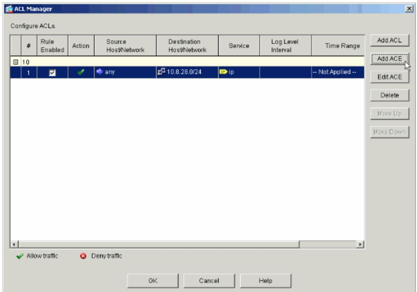
In diesem Beispiel wird ACL 10 ein zweiter ACE hinzugefügt, um den Zugriff auf das Intranet-Subnetz zu ermöglichen.
