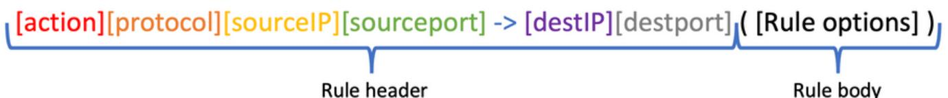
Der Regelheader enthält die Aktion, das Protokoll, das Quell- und das Zielnetzwerk sowie die Ports.
