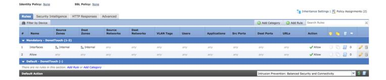
Es gibt zwei Regeln. Bei einer Regel sind Zonen konfiguriert, die Quell- und Zielzone sind jedoch identisch. Die andere Regel hat keine spezifische Konfiguration. In diesem Beispiel wird die Regel für den **Schnittstellenzugriff** nicht in eine Regel umgewandelt.
