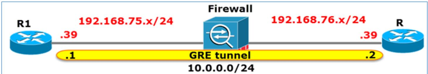
Wenn Sie unter Verwendung eines GRE-Tunnels einen Ping von R1 an R2 senden, wird der Datenverkehr durch die Firewall geleitet. Dies sieht im Bild so aus.
