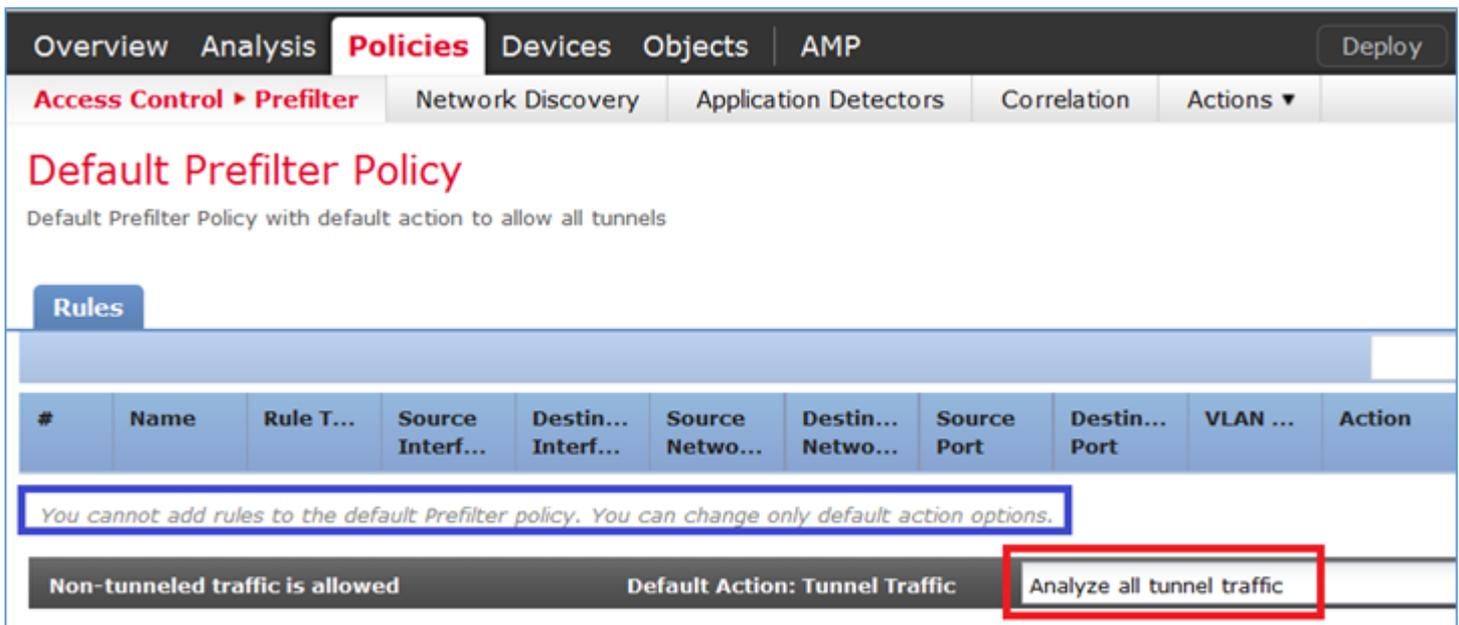
Schritt 3: Die Vorfilterrichtlinie ist bereits der Zugriffskontrollrichtlinie angefügt, wie im Bild gezeigt.
