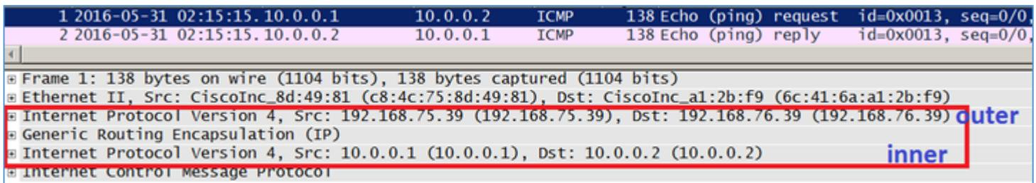
Wenn es sich bei der Firewall um ein ASA-Gerät handelt, wird der äußere IP-Header wie im Abbild dargestellt überprüft.
