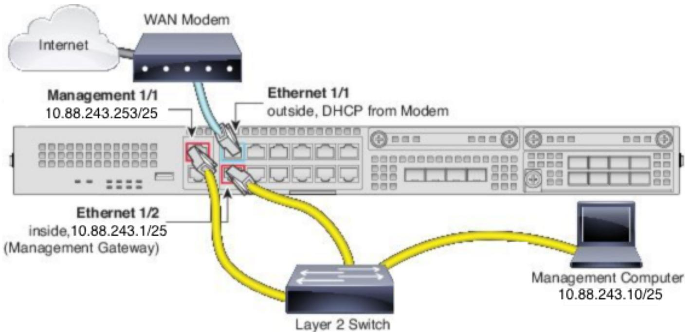
**Hinweis:** Das Bild zeigt eine einfache Topologie, die einen Layer-2-Switch verwendet. Andere Topologien können verwendet werden, und Ihre Bereitstellung kann je nach den grundlegenden Anforderungen an die logische Netzwerkverbindung, die Ports, die Adressierung und die Konfiguration variieren.
