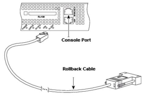
an. Hinweis: Ein gerolltes RJ-45-zu-RJ-45-Flachseil mit RJ-45-zu-DB-25-Adaptern (Teilenummer CAB-25AS-MMOD) an beiden Enden *kann* aufgrund falscher Signalpaare nicht verwendet werden.
