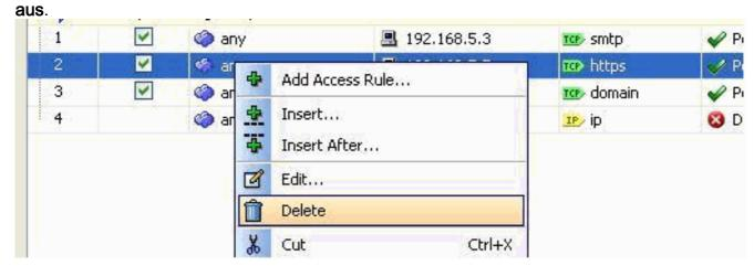
2. Führen Sie denselben Löschvorgang für alle vorhandenen Zugriffsregeln aus, wählen Sie dann die Zugriffsliste aus, und wählen Sie **Löschen aus**, um sie zu löschen.
