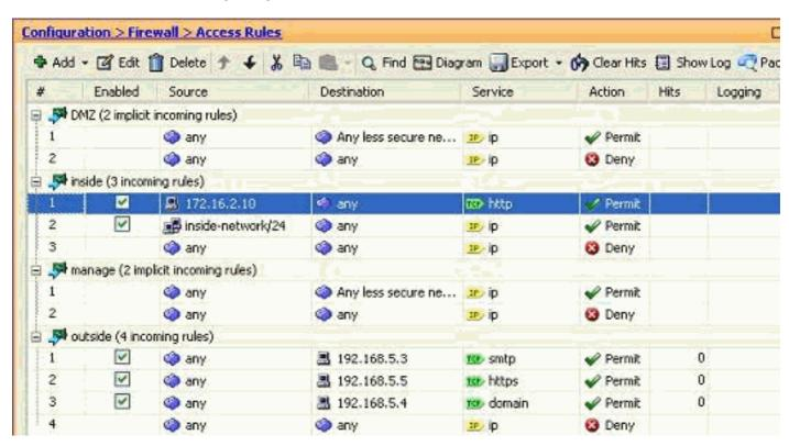
Hinweis: Die Reihenfolge der Zugriffsregeln ist sehr wichtig. Bei der Verarbeitung jedes Pakets zum Filtern prüft die ASA, ob das Paket einem der Kriterien für Zugriffsregeln in sequenzieller Reihenfolge entspricht und ob eine Übereinstimmung vorliegt, die Aktion dieser Zugriffsregel implementiert wird. Wenn eine Zugriffsregel zugeordnet wird, werden keine weiteren Zugriffsregeln angewendet und erneut überprüft.
