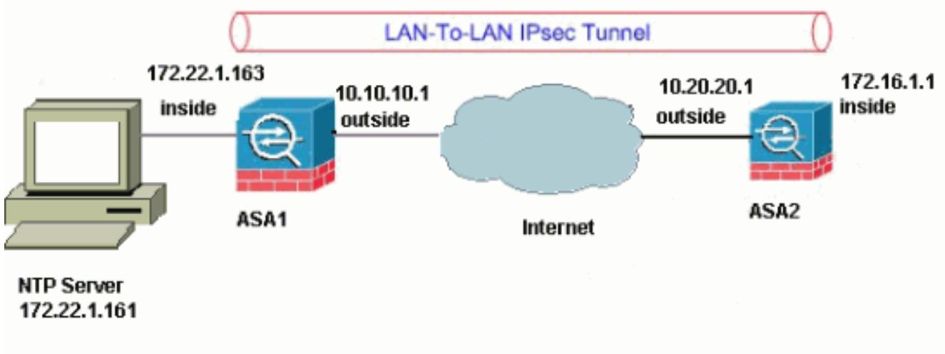
**Hinweis:** Die in dieser Konfiguration verwendeten IP-Adressierungsschemata sind im Internet nicht rechtlich routbar. Sie sind [RFC 1918](#)-Adressen, die in einer Laborumgebung verwendet werden.
