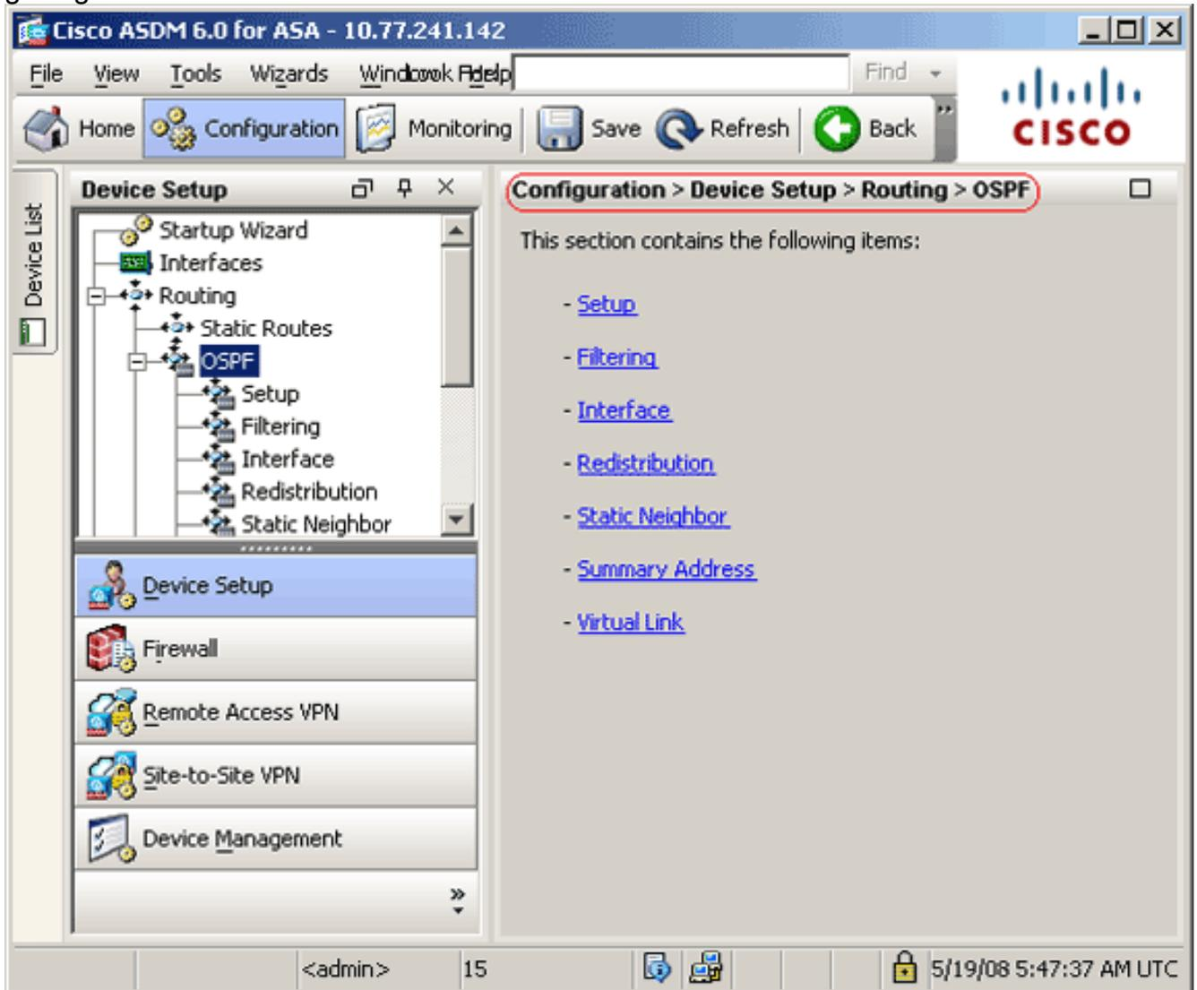
3. Aktivieren Sie den OSPF-Routing-Prozess auf der Registerkarte **Setup > Process Instances (Setup > Prozess Instanzen)**, wie in diesem Bild gezeigt. In diesem Beispiel lautet der OSPF-ID-Prozess
