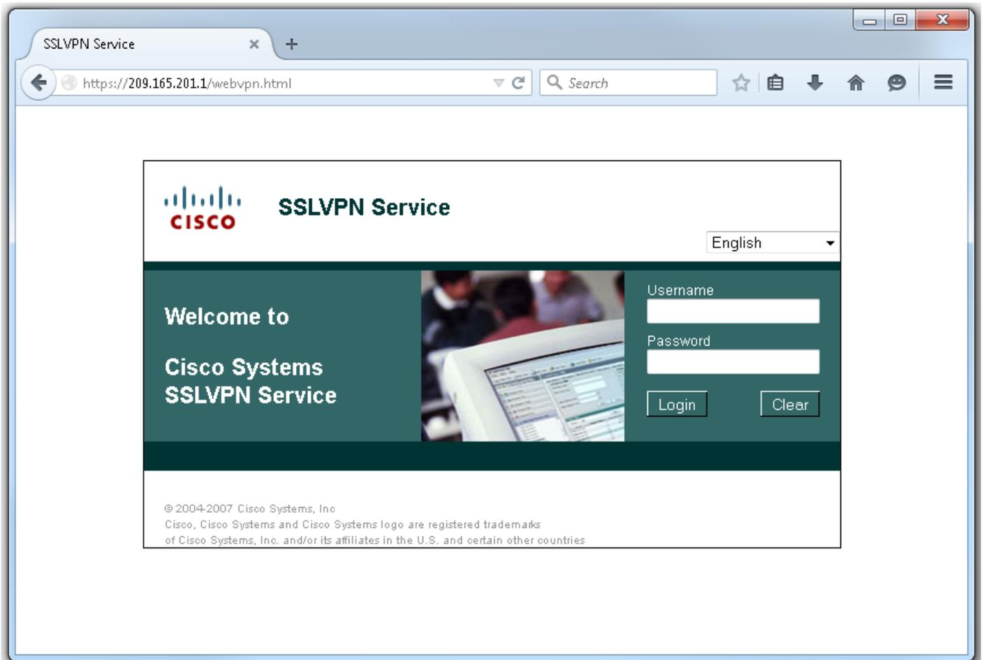
Nach der Anmeldung wird die WebVPN-Startseite angezeigt. Klicken Sie von hier auf **Tunnel Connection (AnyConnect)**. Wenn Internet Explorer verwendet wird, wird ActiveX zum Herunterdrücken und Installieren des AnyConnect-Clients verwendet. Wird sie nicht erkannt, wird stattdessen Java verwendet. Alle anderen Browser verwenden sofort Java.
