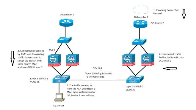
Der für die Inspektion erforderliche Datenverkehr innerhalb eines ASA-Clusters wird in drei Arten klassifiziert:
