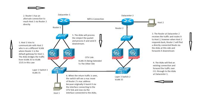
Für eine Kommunikation zwischen Domänen-Controllern (DC) im transparenten Modus ist dieser spezifische Datenverkehrsfluss nicht abgedeckt oder dokumentiert, aber dieser spezifische Datenverkehrsfluss funktioniert vom Standpunkt der ASA-Datenflussverarbeitung aus. Dies kann jedoch dazu führen, dass MAC-Verschiebungsbenachrichtigungen auf dem Switch gesendet werden.
