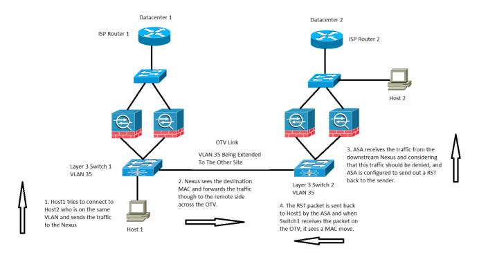
In diesem Fall haben wir einen Host-Host 1 im VLAN 35, der versucht, mit Host 2 im gleichen Layer-3-VLAN zu kommunizieren, Host 2 befindet sich jedoch tatsächlich im Rechenzentrum-2-VLAN 1535.
