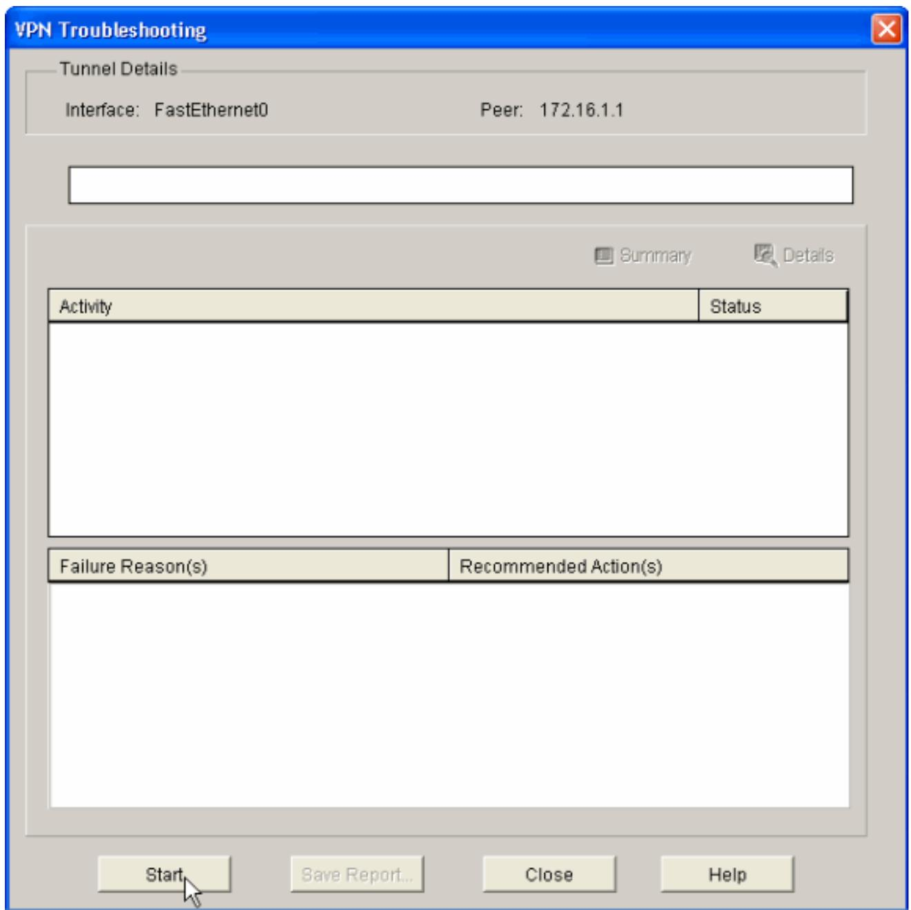
17. Im nächsten Fenster wird das Ergebnis des **VPN-Verbindungstests** bereitgestellt. Hier können Sie sehen, ob der Tunnel **oben** oder **unten** ist. In dieser Beispielkonfiguration ist der Tunnel **nach oben** wie in grün dargestellt.
