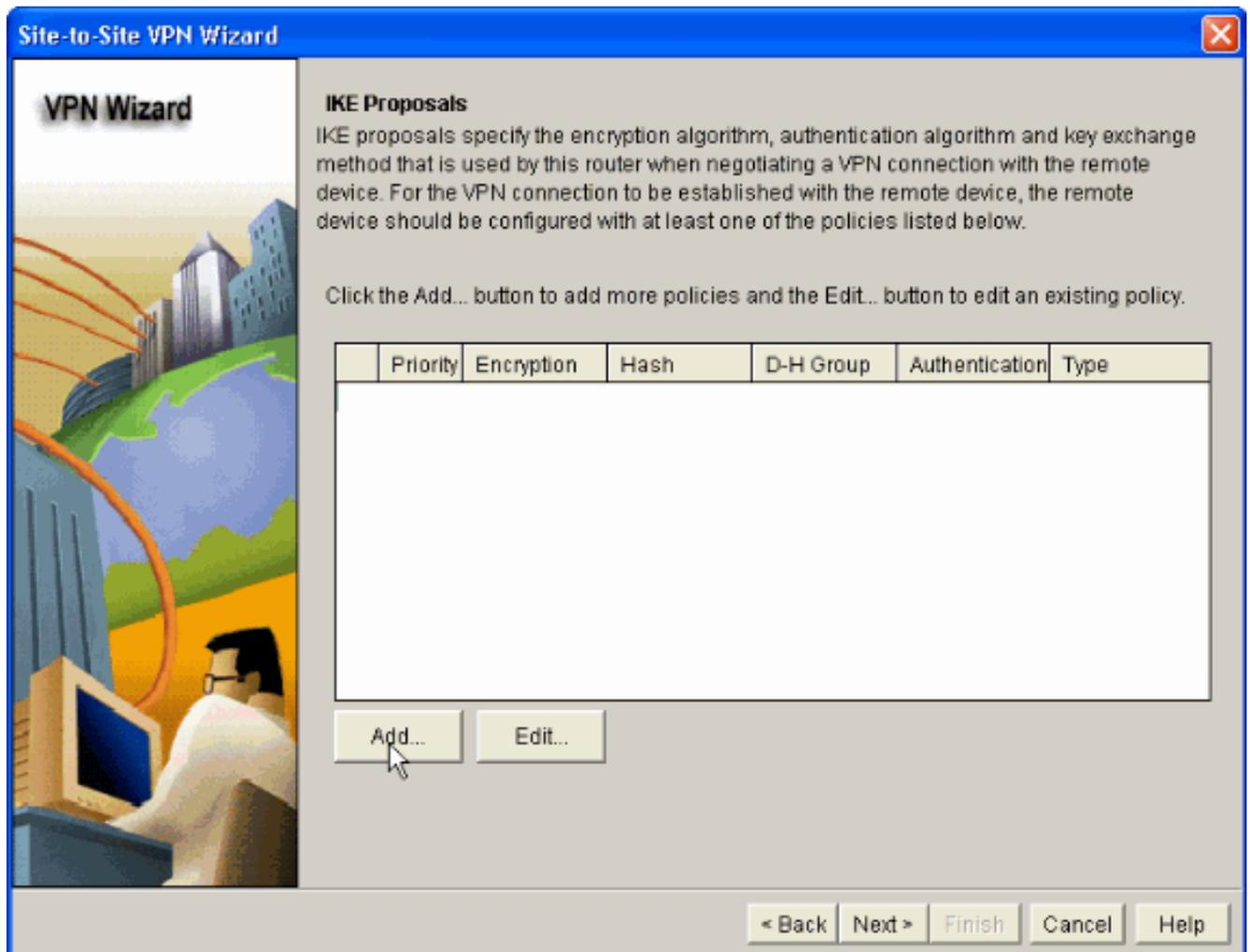
8. Stellen Sie **Verschlüsselungsalgorithmus**, **Authentifizierungsalgorithmus** und die **Exchange-Methode** wie hier gezeigt bereit, und klicken Sie dann auf **OK**. Die Werte **Encryption Algorithm**, **Authentication Algorithm** und **Key Exchange** sollten mit den in der ASA bereitgestellten Daten übereinstimmen.
