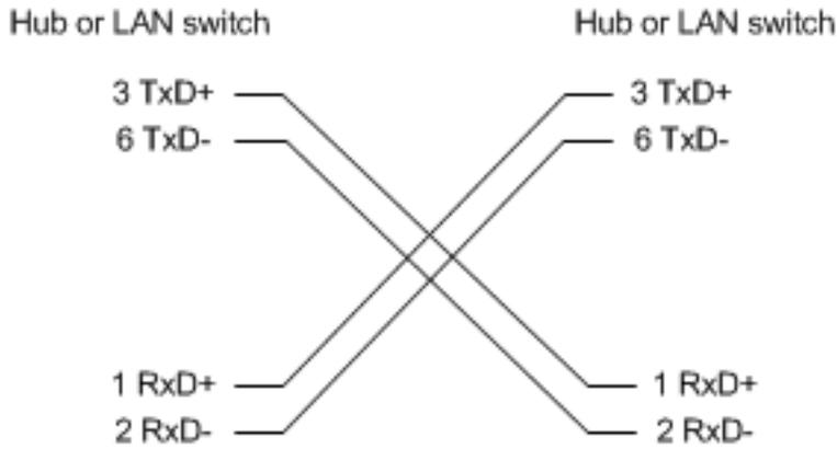
In der Tabelle unten sind die Stiftanordnungen für das Ethernet-RJ-45-Crossover-Kabel aufgeführt.
