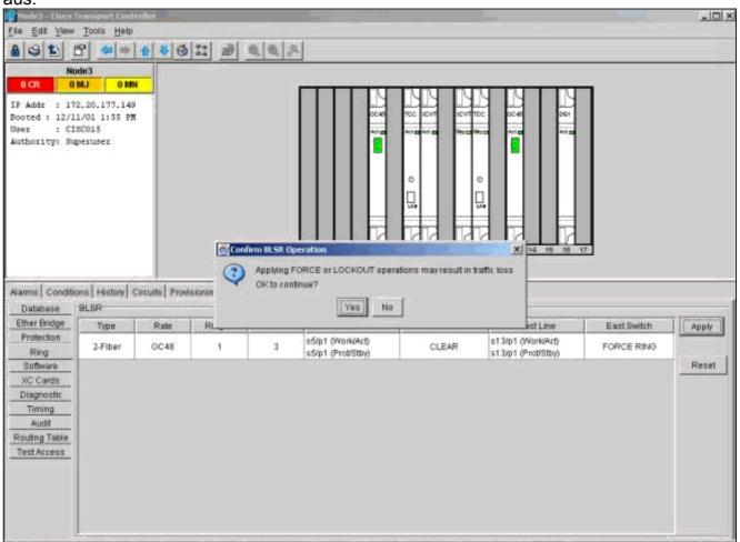
Wählen Sie erneut **Ja** aus. Wechseln Sie jetzt zur Shelf-Ansicht des Knotens, der über den West-Port mit dem neuen Knoten verbunden ist. Fahren Sie hier mit Node1 fort.
