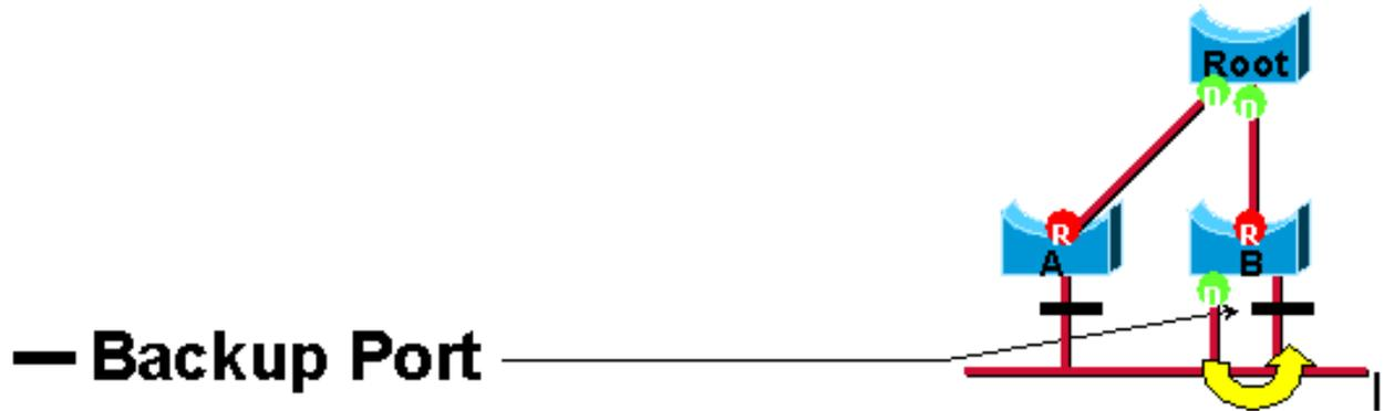
Diese Unterscheidung erfolgt bereits intern in 802.1D. Auf diese Weise funktioniert Cisco UplinkFast. Der Grund hierfür ist, dass ein alternativer Port einen alternativen Pfad zur Root-Bridge bereitstellt und daher den Root-Port bei einem Ausfall ersetzen kann. Ein Backup-Port bietet natürlich redundante Konnektivität zu demselben Segment und kann keine alternative Konnektivität zur Root-Bridge garantieren. Daher wird sie aus der Uplink-Gruppe ausgeschlossen.
