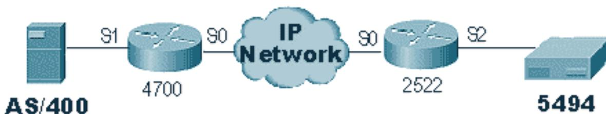
Dieses Szenario verfügt über eine STUN Basic-Konfiguration für die Verbindung des 5494 mit dem AS/400. Bei jeder STUN-Konfiguration muss zuerst überprüft werden, ob die Peers im Router eingerichtet sind. Um dies zu bestimmen, verwenden Sie den Befehl **show stun peer**. Sie liefert Informationen über den Zustand des Peers und die Pakete, die übertragen/empfangen wurden. Nachfolgend finden Sie eine Beispielausgabe:
