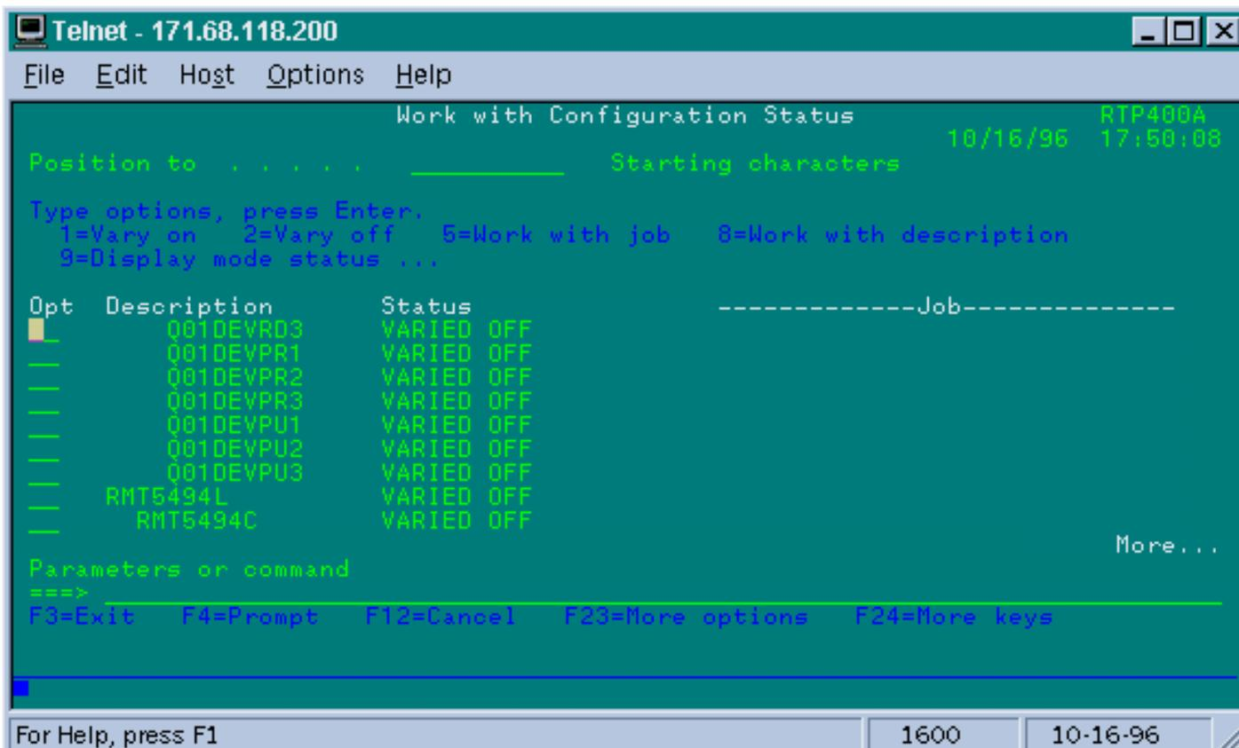
Als Nächstes **variieren Sie je nach** der Leitungsdefinition. Sie sollten dann sehen, dass der Router hochgefahren wird. Wenn die Leitung hochgefahren wird, der Controller aber immer noch nicht aktiviert ist, überprüfen Sie die Schnittstelle, ob Pakete die eingehende Schnittstelle des AS/400 erreicht haben. Wenn die Zahl 0 ist, überprüfen Sie den Kodierungsmechanismus für die SDLC-Leitung auf dem AS/400. Diese befindet sich, wie unten gezeigt, in der Beschreibung der Display-Leitung.
