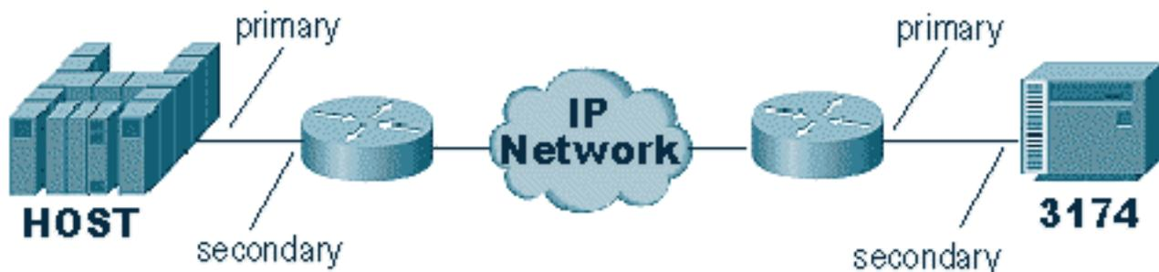
Diese Befehle definieren die "Rolle" des STUN-Setups. Im Fall des Hosts im obigen Diagramm ist der Router auf **primär** festgelegt, d. h. der Host ist derjenige, der die Sitzung initiiert. Damit ist der 3174 **sekundär**. Wenn Sie STUN Basic verwenden, müssen Sie die Rolle nicht definieren, da Sie nicht wissen müssen, wer die Sitzung initiieren wird. Für die lokale Bestätigung sind jedoch Details
