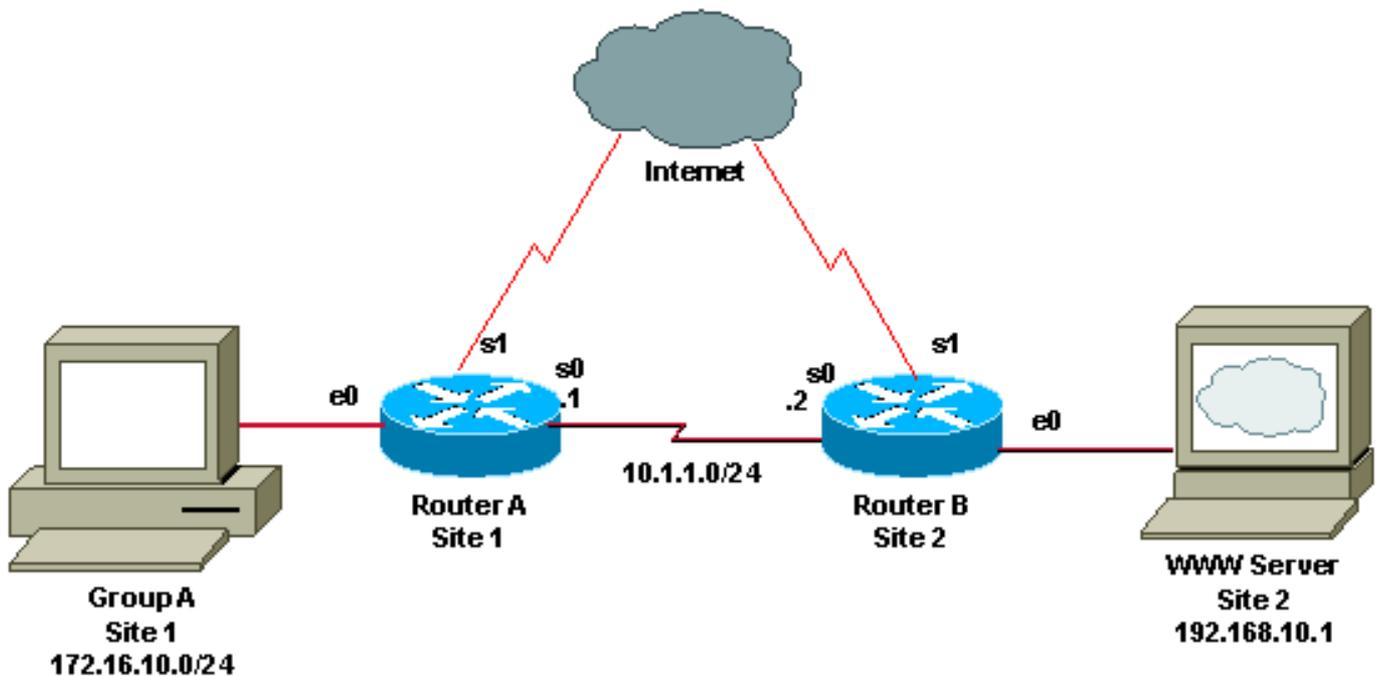
Im Folgenden sehen Sie eine Teilkonfiguration von Router A, die anzeigt, dass eine Richtlinienroute-Map mit dem Namen FOO auf die Schnittstelle e0 angewendet wird, auf der der Datenverkehr von Gruppe A in den Router eingeht:
