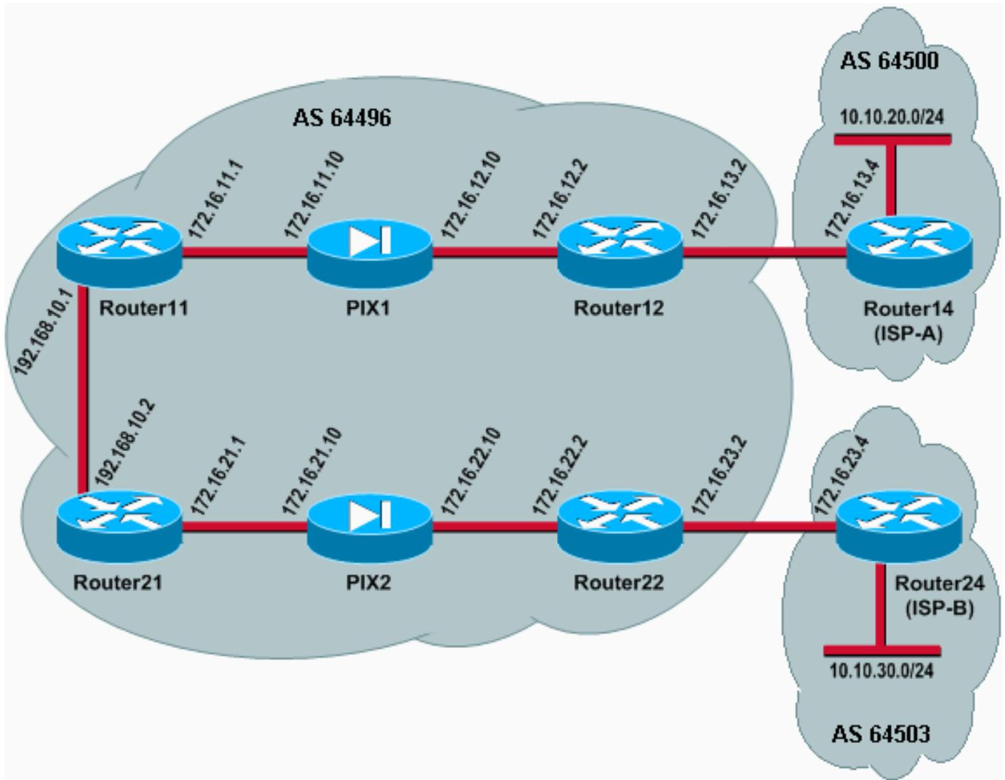
In dieser Netzwerkeinrichtung werden Router12 und Router22 (die zum AS 64496 gehören) aus Redundanzgründen jeweils mit Router14 (ISP-A) bzw. Router24 (ISP-B) verbunden. Das interne Netzwerk 192.168.10.0/24 befindet sich in der Firewall. Router11 und Router21 verbinden sich über die Firewall mit Router12 und Router22. PIX1 und PIX2 sind nicht für die NAT (Network Address Translation) konfiguriert.
