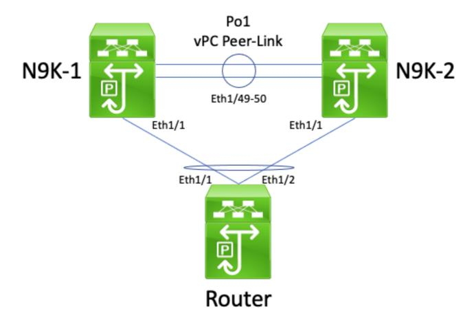
In dieser Topologie sind die Nexus Switches N9K-1 und N9K-2 vPC-Peers in einer vPC-Domäne, in der die vPC-Peer-Gateway-Erweiterung aktiviert ist. Die Schnittstelle Po1 ist der vPC-Peer-Link. Ein Router mit dem Hostnamen Router ist über vPC Po10 mit N9K-1 und N9K-2 verbunden. Die
