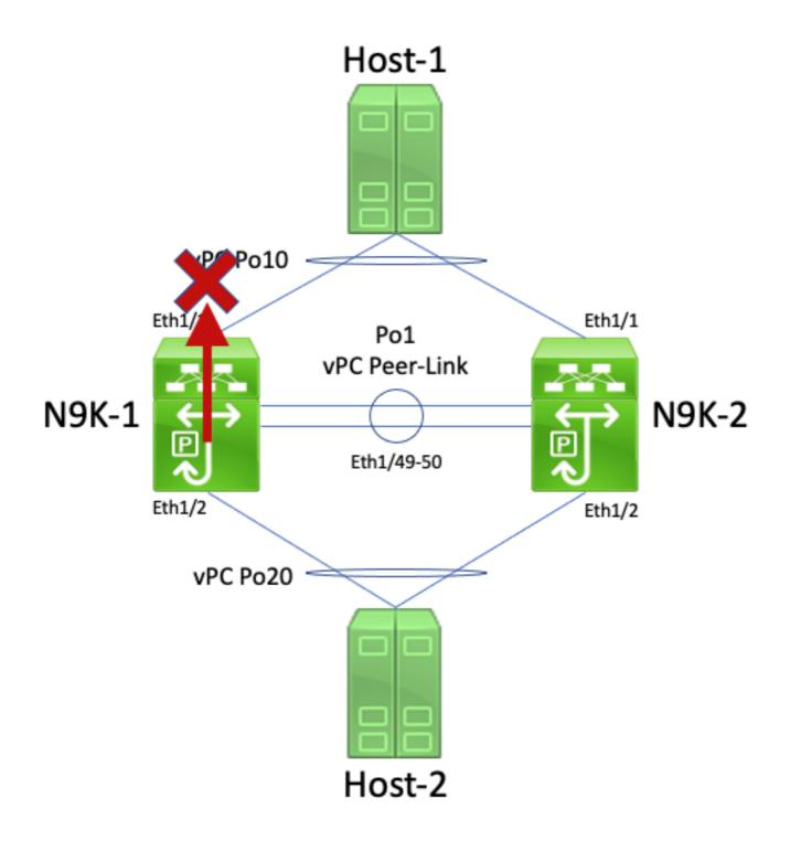
Sie können dieses Problem beheben, indem Sie die vPC-Peer-Gateway-Erweiterung mit dem Konfigurationsbefehl für die vPC-Domäne **Peer-Gateway** aktivieren. Dadurch kann N9K-2 das ICMP-Echo-Reply-Paket (und andere Pakete, die ähnlich adressiert sind) im Auftrag von N9K-1 weiterleiten, obwohl die Ziel-MAC-Adresse des Pakets N9K-1 gehört und nicht N9K-2. Daher kann N9K-2 dieses Paket von seiner vPC-Po10-Schnittstelle weiterleiten, anstatt es über den vPC-Peer-Link weiterzuleiten.
