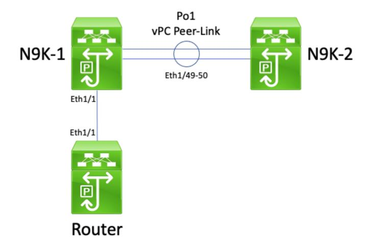
In dieser Topologie sind die Nexus Switches N9K-1 und N9K-2 vPC-Peers in einer vPC-Domäne, in der die vPC-Peer-Gateway-Erweiterung aktiviert ist. Die Schnittstelle Po1 ist der vPC-Peer-Link. Ein Router mit dem Hostnamen Router ist über Ethernet1/1 mit Ethernet1/1 von N9K-1 verbunden.
