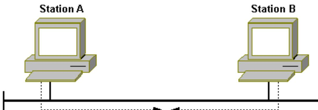
1. Station A möchte einen Frame senden. Zunächst wird geprüft, ob das Medium verfügbar ist (Carrier Sense). Ist dies nicht der Fall, wartet er, bis der aktuelle Absender des Mediums fertig ist.
