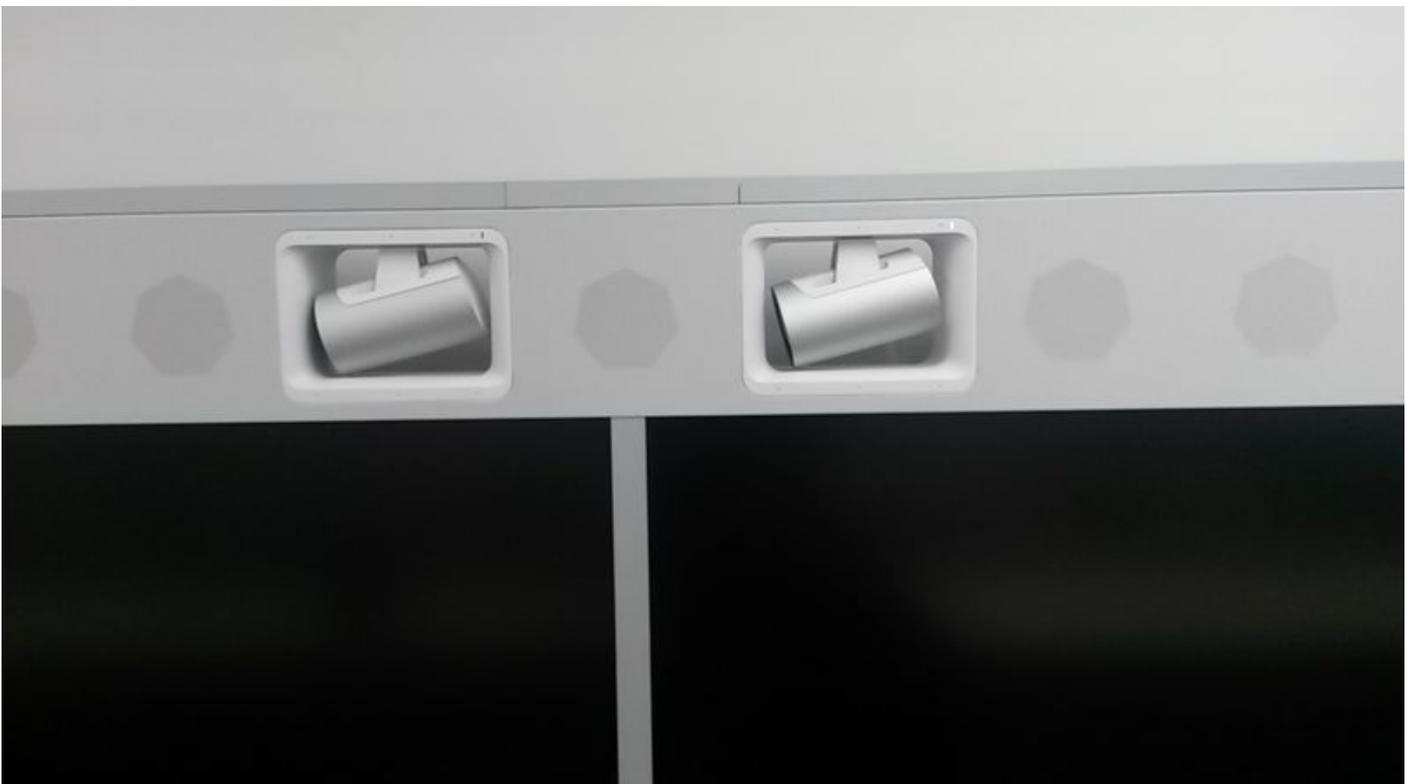
Schritt 1: Entfernen Sie die obere Abdeckung, wie im Bild gezeigt.
