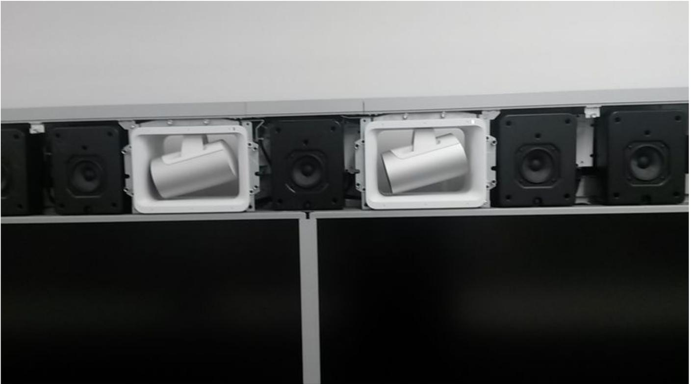
Schritt 2: Entfernen Sie die Lautsprecher links, rechts und in der Mitte neben den Kameras, wie im Bild gezeigt.
