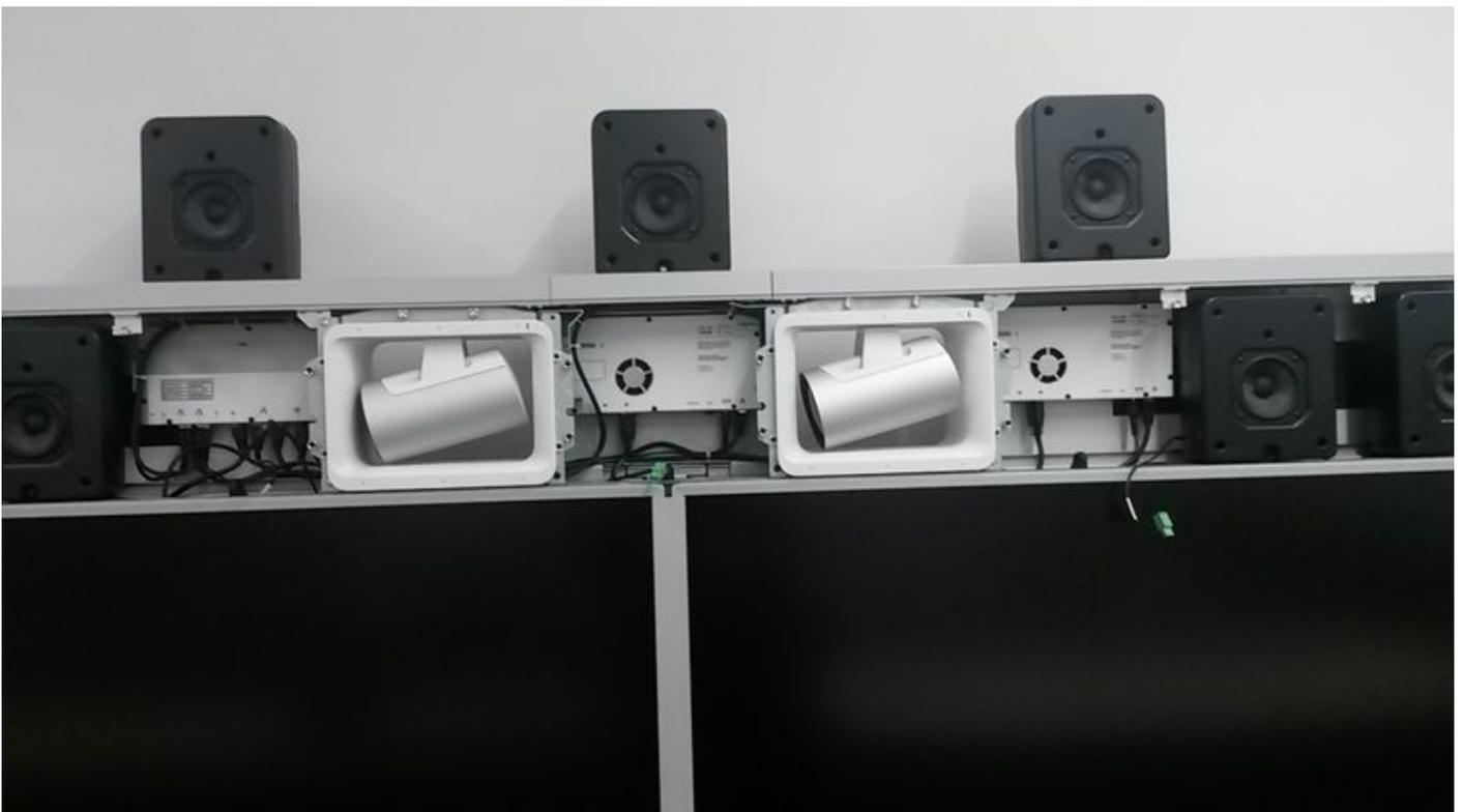
Schritt 3: Um die Kameras einzeln zurückzusetzen, gehen Sie auf die rechte Seite jeder Kamera, Sie können einen Lüfter in jedem Gerät sehen, wie im Bild gezeigt.
