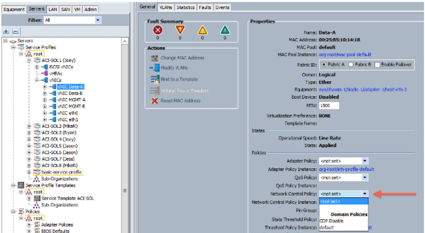
In Version 2.2(4b) und höher unterstützt das UCS das Link Layer Discovery Protocol (LLDP) von den Fabric Interconnects bis hin zu den Blades. Dies bedeutet, dass Sie LLDP auch verwenden können, um die Hosts in vCenter und der Fabric zu erkennen, wenn Sie diese Version oder eine spätere Version ausführen. Die Konfiguration entspricht der oben beschriebenen Konfiguration, Sie aktivieren jedoch LLDP in beide Richtungen:
