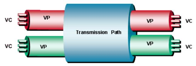
Im <u>Diagramm</u> oben werden ATM-Zellen, die im VC eintreffen, auf Basis der VPI- und VCI-Nummer im Zell-Header umgeschaltet. Andererseits werden ATM-Zellen, die bei VP eintreffen, nur anhand der VPI-Nummer geswitcht. Die Konfiguration des ATM-Switches bestimmt, ob der Switch ein VC-oder VP-Switch für ein bestimmtes VPI/VCI-Paar bzw. ein VPI sein soll.
