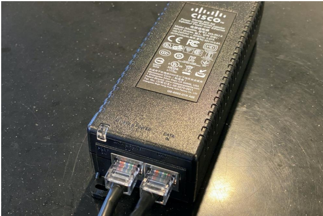
▲透過另一條網路線與家中網路數據機串接，並且連接電源即可開始使用
