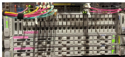
NCS540で高精度時刻同期 UCSサーバ上でCU/DU, 5GC構築
