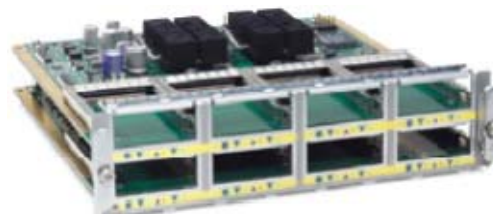
图7. 8端口（2:1）万兆以太网（X2）扩展卡（可兼容思科TwinGig转换器模块）
