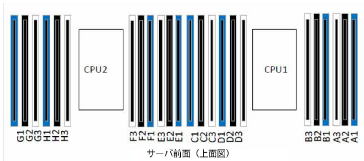
図 11 CPU DIMM チャンネルおよびスロットの物理レイアウト
