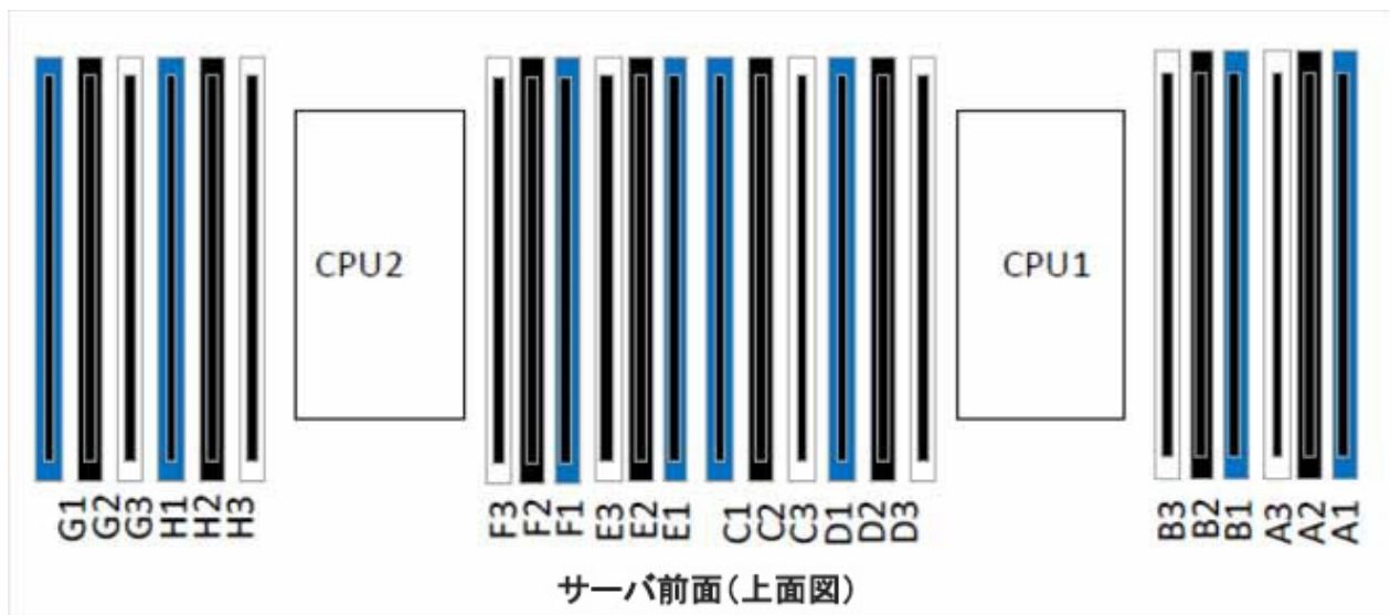
図 8 CPU DIMM チャンネルおよびスロットの物理レイアウト
