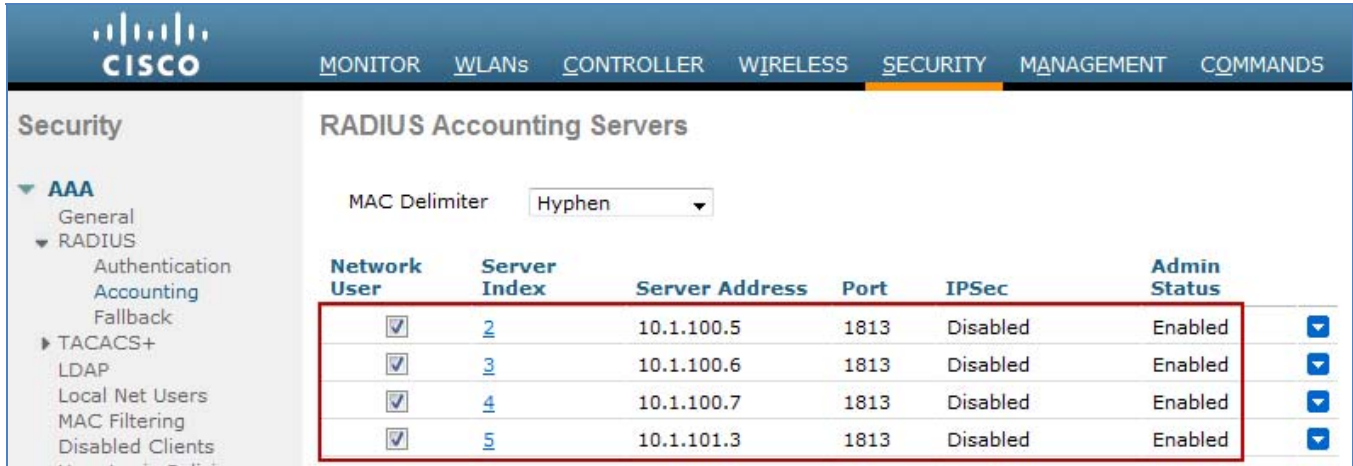
图 10. 无线控制器的全局 RADIUS 记帐配置示例
